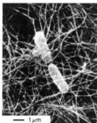
図1 酢酸菌と産生された結晶性セルロースナノ繊維 (幅40～60 nm) よりなるペリクル (ナタデココ) の電子顕微鏡像
